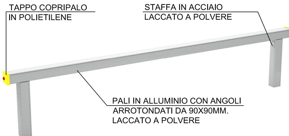
TUTTI GLI ELEMENTI DI FISSAGGIO, VITI, DADI, RONDELLE ECC. SONO IN ACCIAIO ZINCATO E PROTETTI DA GHIERE E TAPPI IN POLIETILENE.
